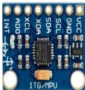
Hình 6: Cảm biến vị trí và góc nghiêng của xe.
