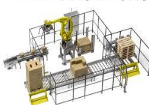
Hình 4: Mô hình một hệ thống Robot bốc xếp tự động
